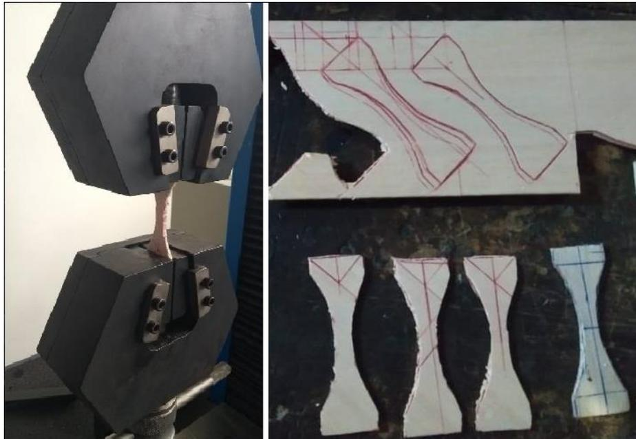
Figura 11 – Ensaio mecânico realizado na madeira balsa.
