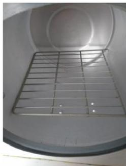
**Figura 8.** Grade de apoio no interior do equipamento
