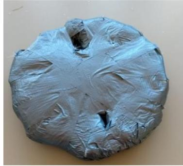
**Figura 6.** Isolamento móvel no molde da tampa e isolamento fixo no molde do casco cilíndrico
