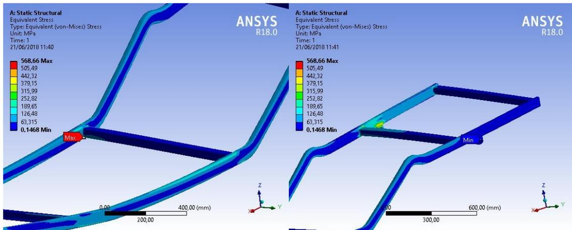
Figura 11. Tensão Equivalente de von Mises
