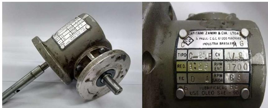
**Figura 3.** Redutor utilizado na bancada
