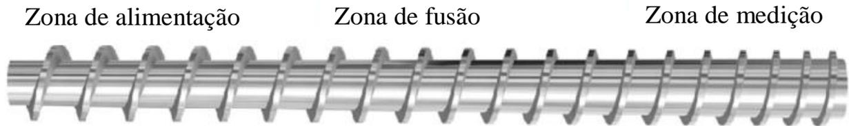
**Figura 4.** Esquemático de um parafuso extrusor simples, com zonas delimitadas (Sanjabi, 2010, com adaptações)
