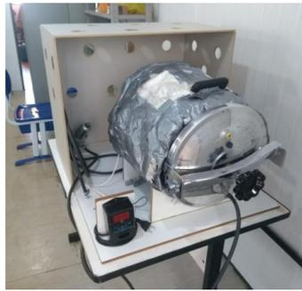
**Figura 9.** Equipamento Autoclave construído na Universidade de Brasília
