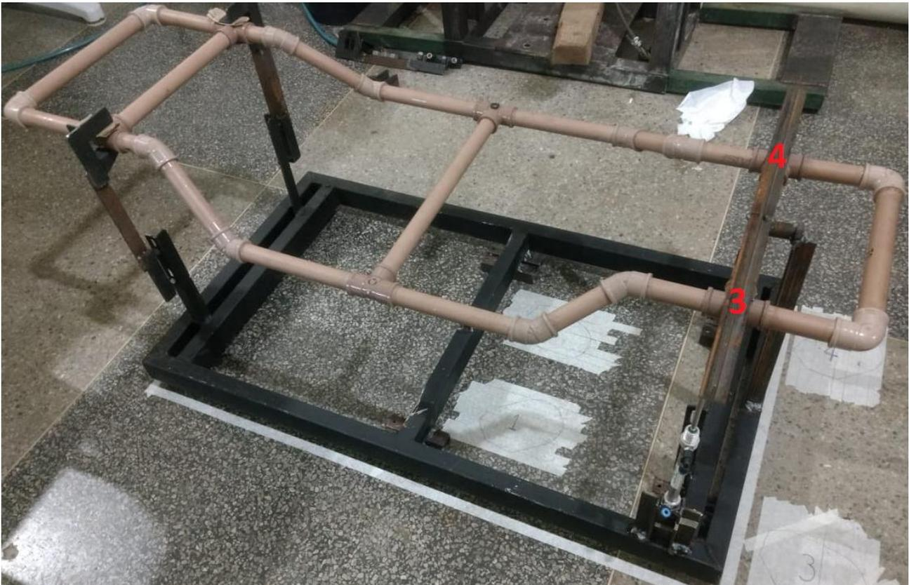
**Figura 5** – Pontos onde foram medidos os deslocamentos
