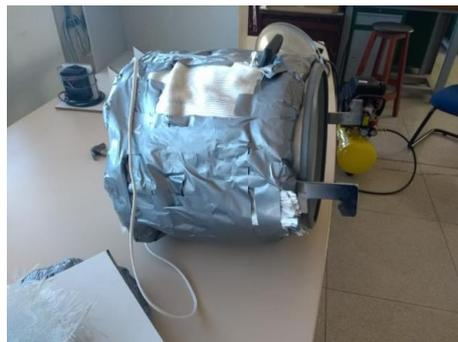
**Figura 5.** Isolamento fixo instalado ao vaso de pressão.
