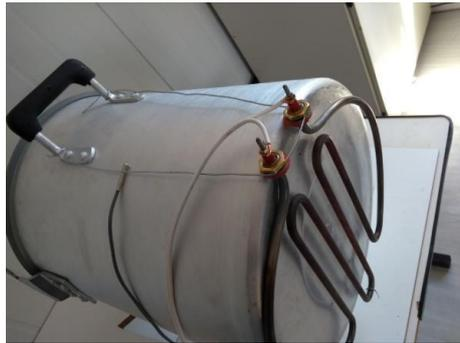
**Figura 2.** Fixação da resistência e termopar medindo temperatura da parede externa
