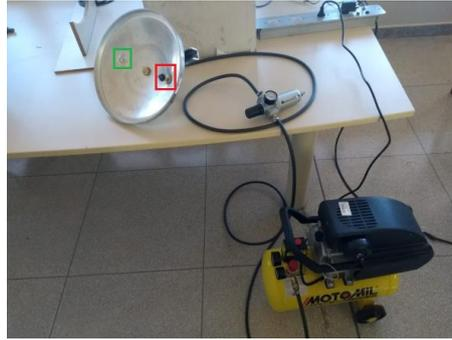
**Figura 3.** Sistema de pressurização com destaque na tampa da panela em vermelho para válvulas de seguranças e em verde para entrada da mangueira vinda do compressor
