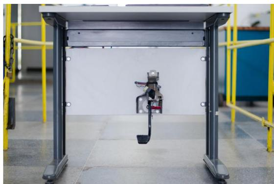
**Figura 6.** Tampo vertical da bancada com pedal de freio montado (Autoria Própria)
