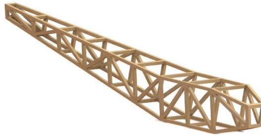
**Figura 11.** Vista isométrica da fuselagem criada no Solidworks
