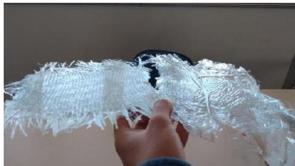
**Figura 9.** Compósito curado na autoclave (esquerda) e à temperatura ambiente (direita)
