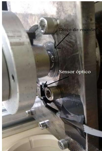
**Figura 9.** Montagem do sensor *encoder*
