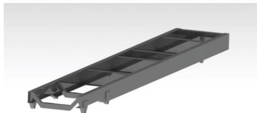
**Figura 1.** Modelo do chassi em CAD
