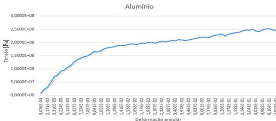
Figura 13. Gráfico tensão-deformação resultante do ensaio
