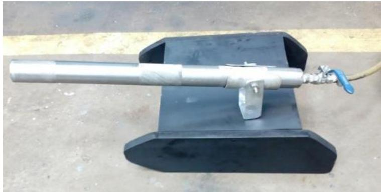
**Figura 7.** Protótipo do canhão e tanque
