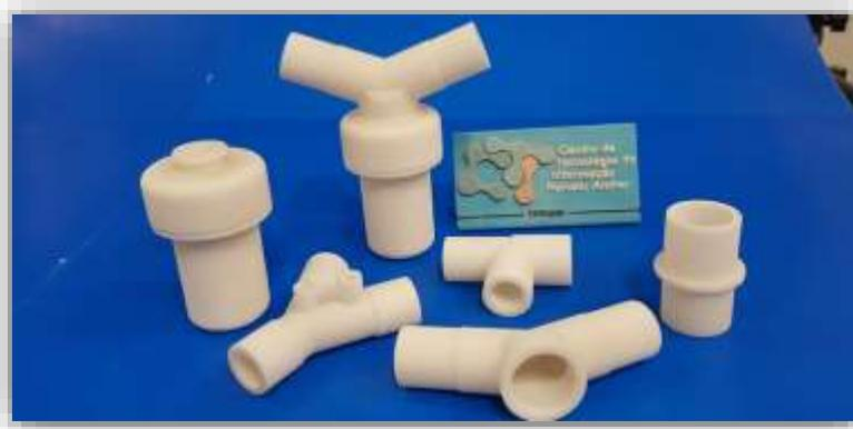
Elementos adaptados para reposição do ventilador fabricados em técnica aditiva por leito de pó fundido (SLS). Local: CTI- Campinas.
