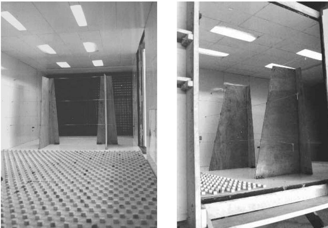
Figura 2. Elementos de rugosidad y simuladores de Standen utilizados en la simulación.
