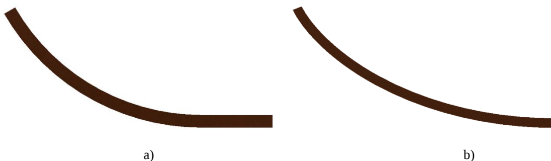
Figura 1. Modelos geométricos desenvolvidos para os dois formatos de curvas de calha avaliados no estudo. a) Curva convencional b) Curva cicloidal
