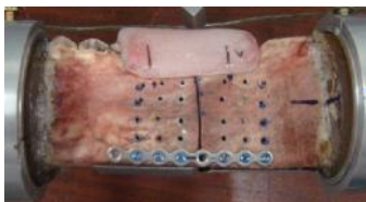
Figura 2. Fixação da miniplaca e furo da miniplaca posicionado no centro da linha de corte sem parafuso
