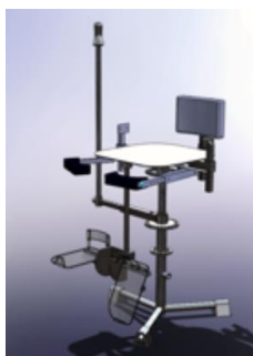
Figura 4 – Projeto de um banco regulável ( Uniform throwing chair ) (CHUNG, LIN, et al. , 2010).
