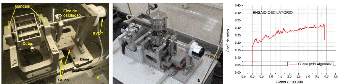
Figura 5 – Dispositivo, acoplamento ao tribômetro e curva do ensaio no modo oscilatório
