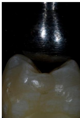
Figura 3. Aplicação de carregamento axial com esfera 8mm de diâmetro até a fratura.
