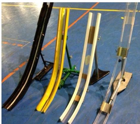
Figura 1. Calhas A, B, C, e D com diferentes tipos de ângulo e material.
