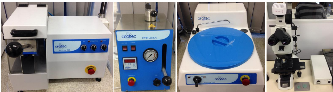
Figura 2. Equipamentos utilizados na análise metalográfica.
