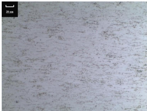
Figura 3. Microestrutura da haste femoral canulada, 500x de aumento, ataque Kroll por 15 s.
