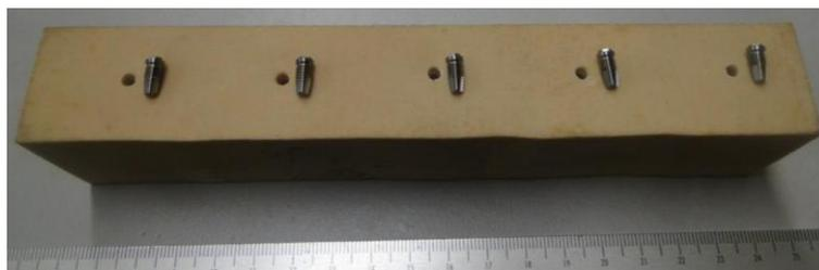
Figura 4. Corpos de prova após ensaio de torção/remoção.
