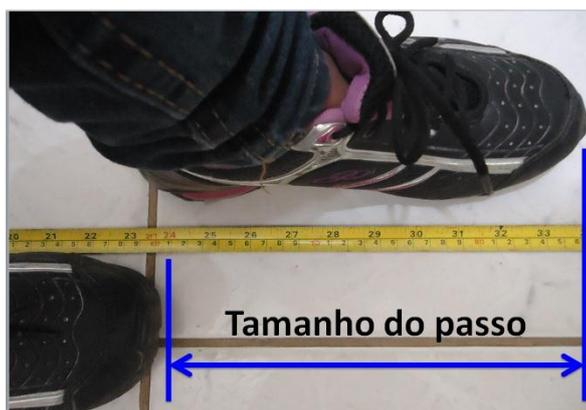
Figura 1. Experimento de análise da variação da passada ao longo de uma distância D onde com o auxílio de uma fita métrica posicionada entre os pés foi possível saber a posição de cada pé no trajeto.
