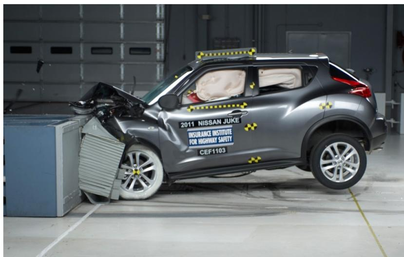
Figura 1 – Colisão de veículo durante teste de impacto (Nissan, 2011)
