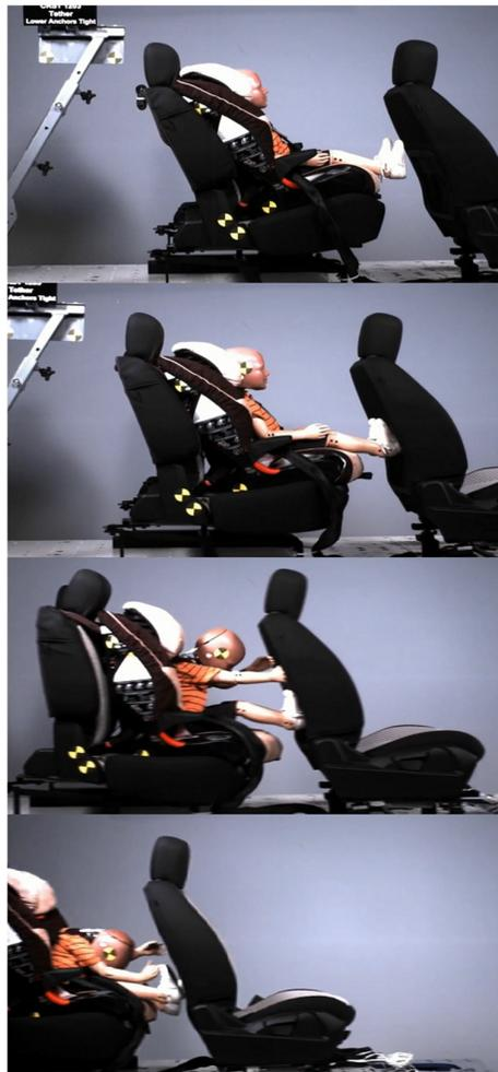
. Figura 3 – Sequência de Movimentos do ‘dummy’ durante a colisão [4].
