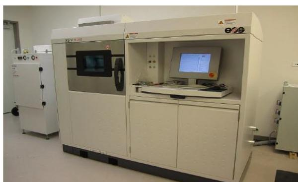
Figura 5 – Sinterização a laser.
