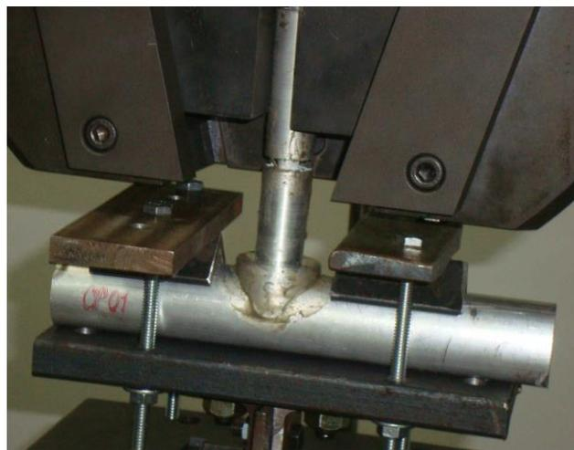
Figura 6. Corpo de prova adesivado em ensaio.
