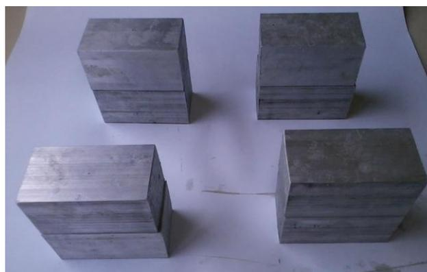
Figura 8. Barras de alumínio adesivadas para testar resistência do adesivo quando submetido ao processo de usinagem.
