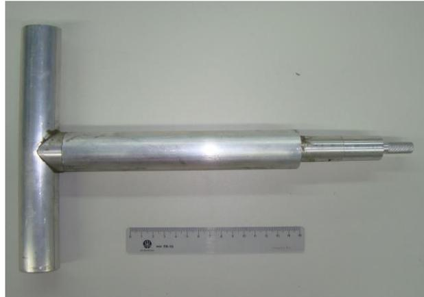
Figura 5. Corpo de prova adesivado para ensaio de tração.
