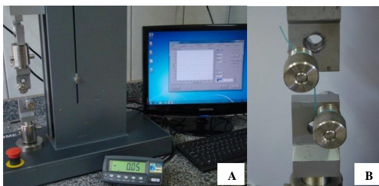
Figura1 – Aparato experimental utilizado nos testes de tração. (A) Máquina de ensaio, (B) Garras para fixação dos fios.
