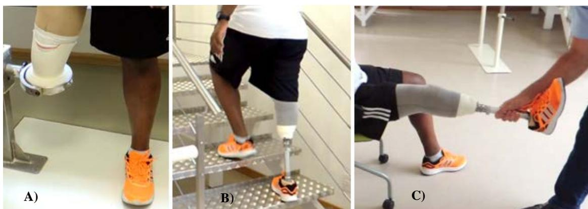
Figura 4. A) Prueba inicial del socket. B) Paciente subiendo escaleras con prótesis montada en socket de nylon 12 por SLS. C) Se comprueba la succión de la prótesis.
