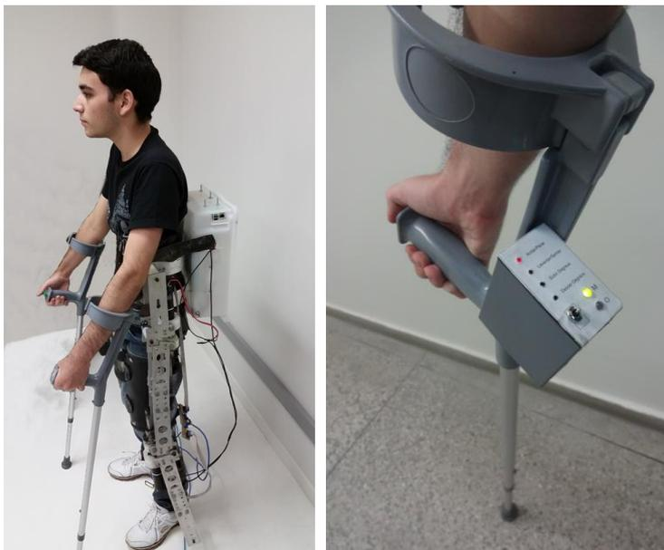
Figura 2. Usuário utilizando a órtese ativa para membros inferiores Ortholeg com a IHM baseada em botões nas muletas.
