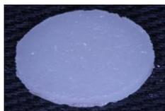
Figura (1). Disco de cerâmica feldspática.
