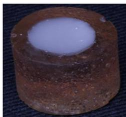
Figura (2). Disco de cerâmica feldspática incluído em cilindro de resina de poliestireno.
