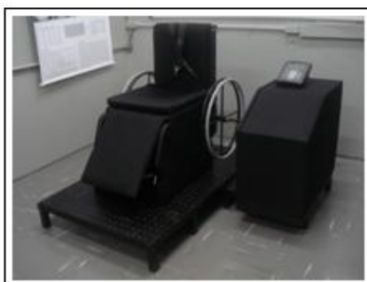
Figura 2.2 – Primeiro protótipo do ergômetro para cadeirantes projetado e construído no LPM.
