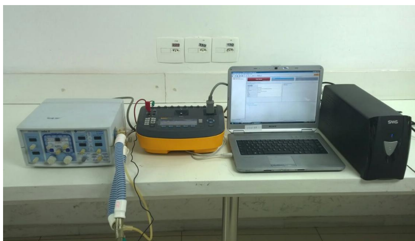
Figura 2- Medição do Teste de Segurança Elétrica.
