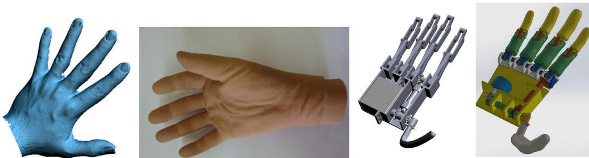
Figura 5. Imagem de mão modelo digitalizada e luva estética com projeto de modelo articulado com barras e modelo com formas antropomórficas dos dedos (Polis, 2009)
