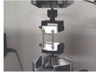
**Figura 4: Sistema de implante fixado na MTS.**
