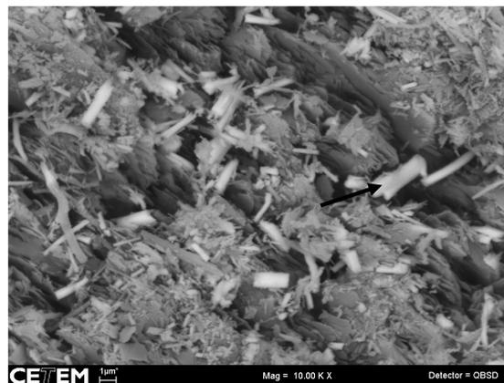
Figura 3: Cristais de piromorfita (seta) em esponja recoberta com HA após 1 hora de contato com  $Pb^{2+}$ .
