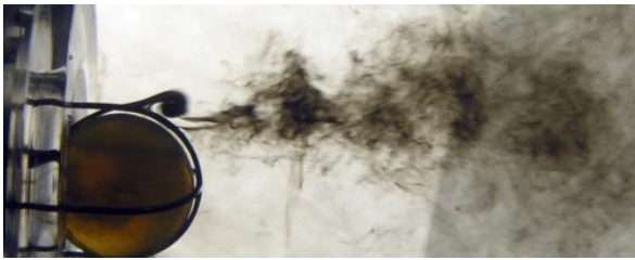
Figura 3: Visualização de vórtices na válvula de esfera.
