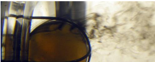
Figura 4: Presença de descolamento da camada limite.
