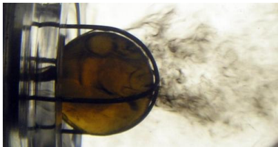
Figura 3: Visualização de vórtices na válvula de esfera.
