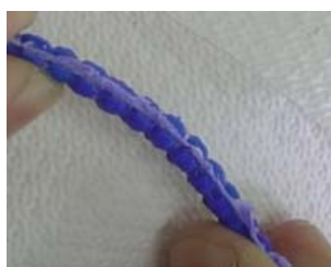
Figura 3: Clavo prototipo PDS nucleado con BN.
