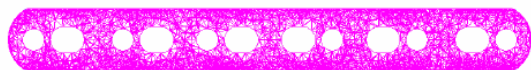
Figura 4: Exemplo da geração da malha de elementos finitos durante a fase de pré-processamento por um sistema CAE, de uma placa de fixação, (Fonte [5]).
