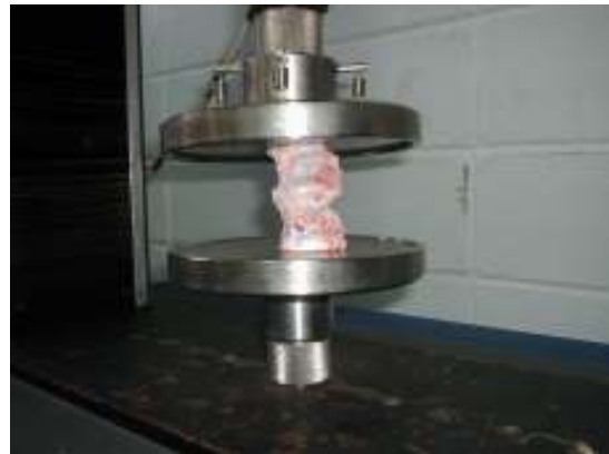
Figura 1 – Unidade funcional da coluna vertebral lombar sendo submetida à compressão axial.
