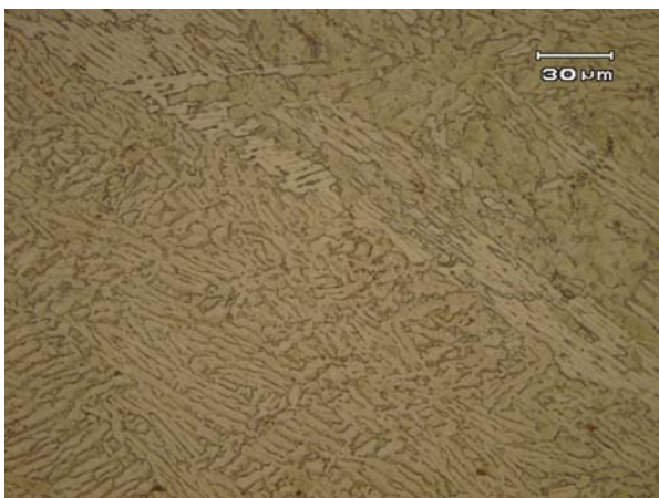
Figura 5: Microestrutura dos parafusos composta por grãos alfa e beta aciculares.
