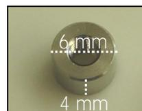
Figura 2: Implantes de Ti ASTM grau 4 do tipo disco.
