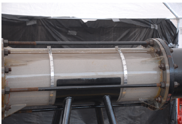
Figura 12. Detalhe da janela de acrílico para visualização com o leito produzido pela onda alfa
