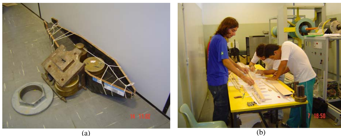
Figura 5: Projetos em construção: (a) Fuselagem em honeycomb ; (b) construção da asa.
