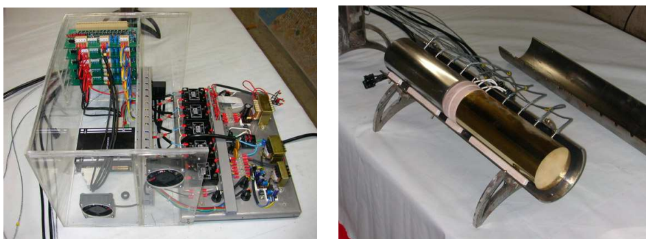
Figura 5. Fotos da montagem: a. blocos de chaveamento, digitalização e comunicação b. aparato experimental.
