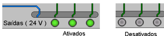
Figura 8. Detalhe dos LEDs Indicativos das Saídas.
