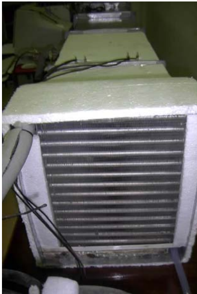
Figura 2. Foto da serpentina de resfriamento posicionada na entrada do túnel. Ao lado observa-se o diagrama psicrométrico do processo de desumidificação
