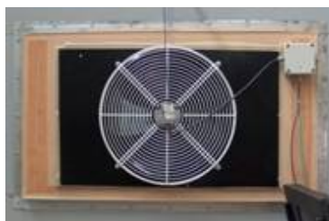
Figura 11. Ventilador axial de 450mm
