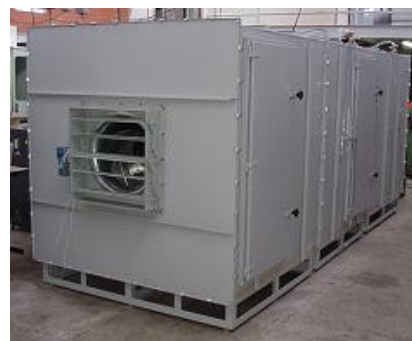
Figura 4. Câmara de bocais
