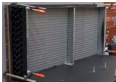
Figura 22. Condensador de 5,0 HP
