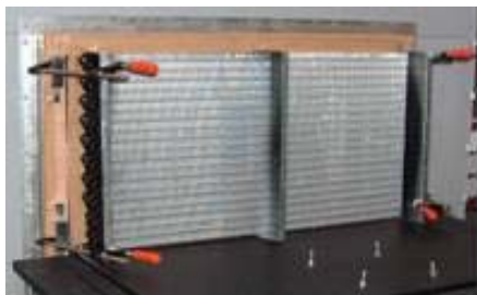
Figura 21. Condensador de 3,5HP
