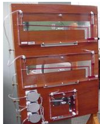
Figura 6. Manômetros de coluna de óleo e Transdutores de pressão
