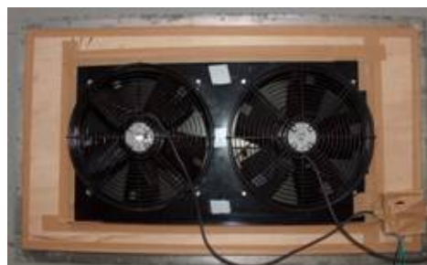
Figura 18. Ventiladores de 350mm em paralelo
