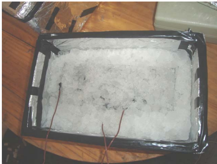
Fig. 5. Detalle del módulo con hielo.
