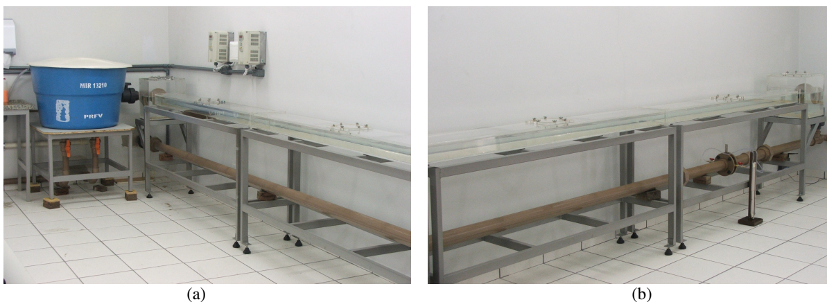
Figura 2. Montagem experimental real. (a) Vista parcial seção de teste; (b) Vista da região de entrada e medidor de vazão.
