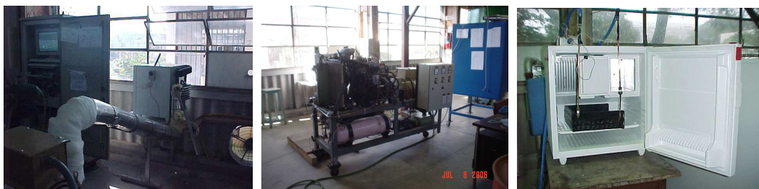
Figura 2. Sistema de trigeração: aquisição de dados e URABS (esquerda), UGPE (centro) e trocador de calor de água usado como carga térmica (direita).
