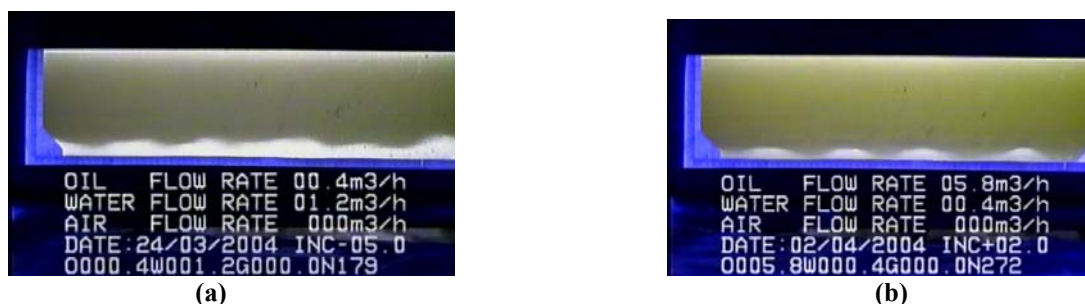
Figura 1. Ondas interfaciais observadas; (a) inclinação de 5 graus negativos; (b) 2 graus positivos.
