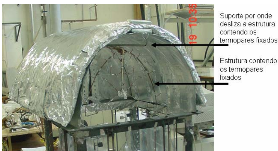
Figura 5: Foto ilustrando a estrutura que corre ao longo do comprimento do forno.
