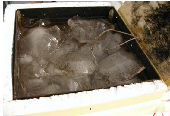
(b) Tanque com o banho de gelo
