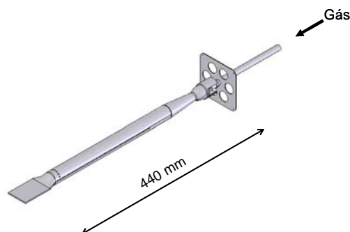
Figura 2: Esboço em escala do queimador.
