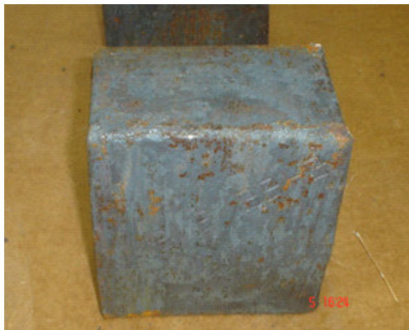
Figura 4. Bloco amostra retirado do tarugo do aço de trabalho e desenho esquemático da retirada de amostra para procedimento metalográfico.
