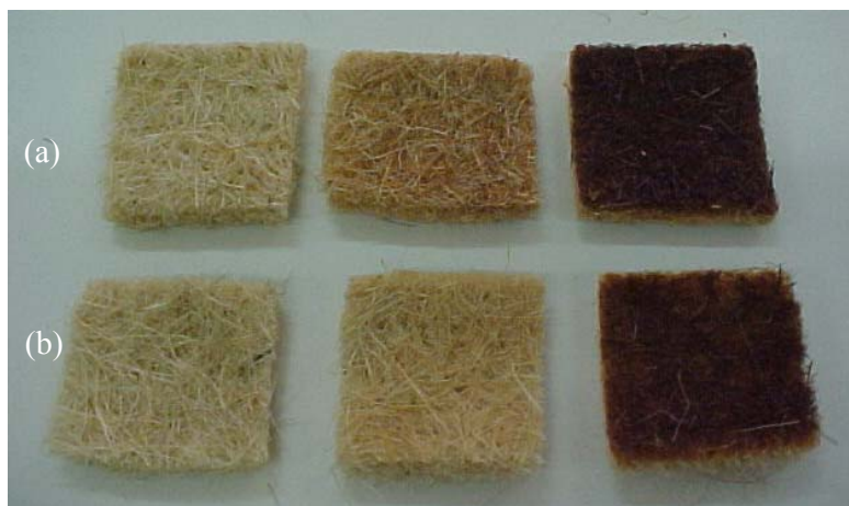
Figura 9. Amostras das mantas de sisal após experimentos: (a) in natura (b) Tratadas
