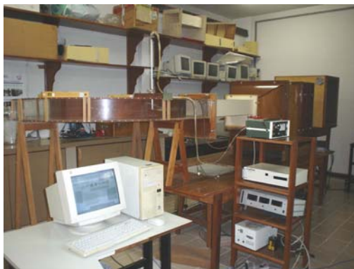
Figura 1 (a) O túnel de vento.
