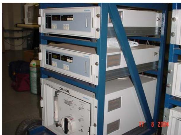
Figura 4. Analisadores de gases (HORIBA).
