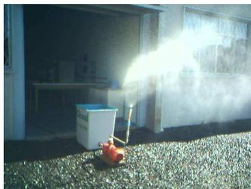
Figura 5 – Foto do teste de comportamento do bico de aspersão Vista
