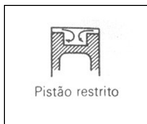
Figura 10 – Geometria do pistão restrito.
