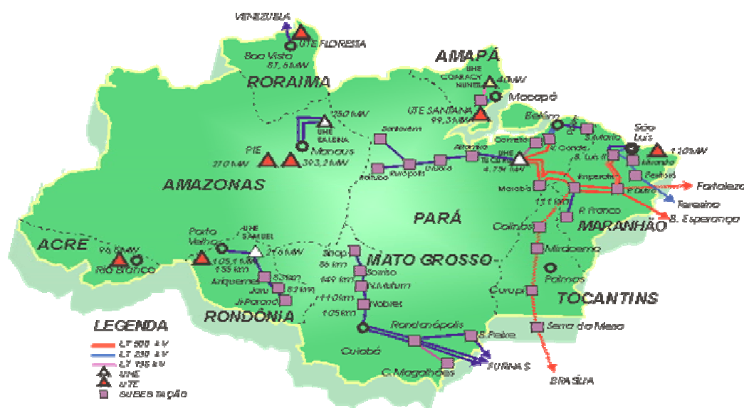
Figura 1. Mapa da rede de geração e transmissão de energia elétrica gerenciadas pela ELETRONORTE, nota - se que os sistemas não se limitam aos estados da Região Norte
