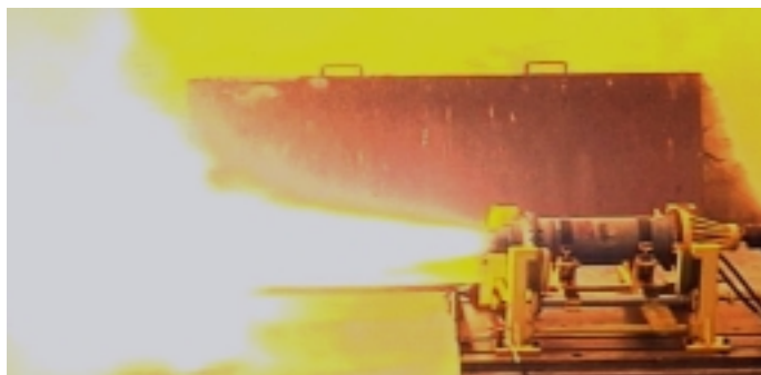
Figura 2. Motor instalado no banco de ensaios.
