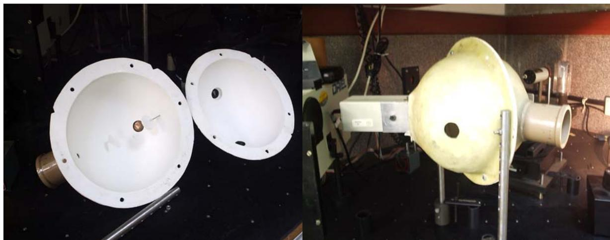
Figura 3. Esfera de integração em detalhes.
