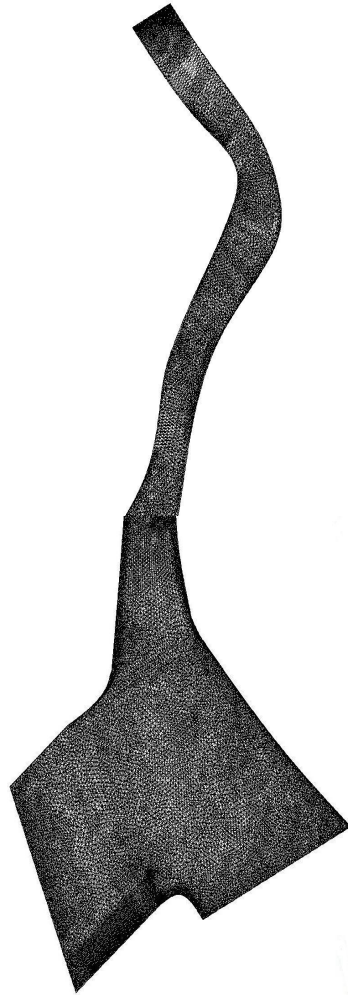
Figura 4: Malha 3D gerada no CFX. Pré-processamento do Canal da Foz do Rio Matapi e encontro com o Canal do Norte, no Rio Amazonas.
