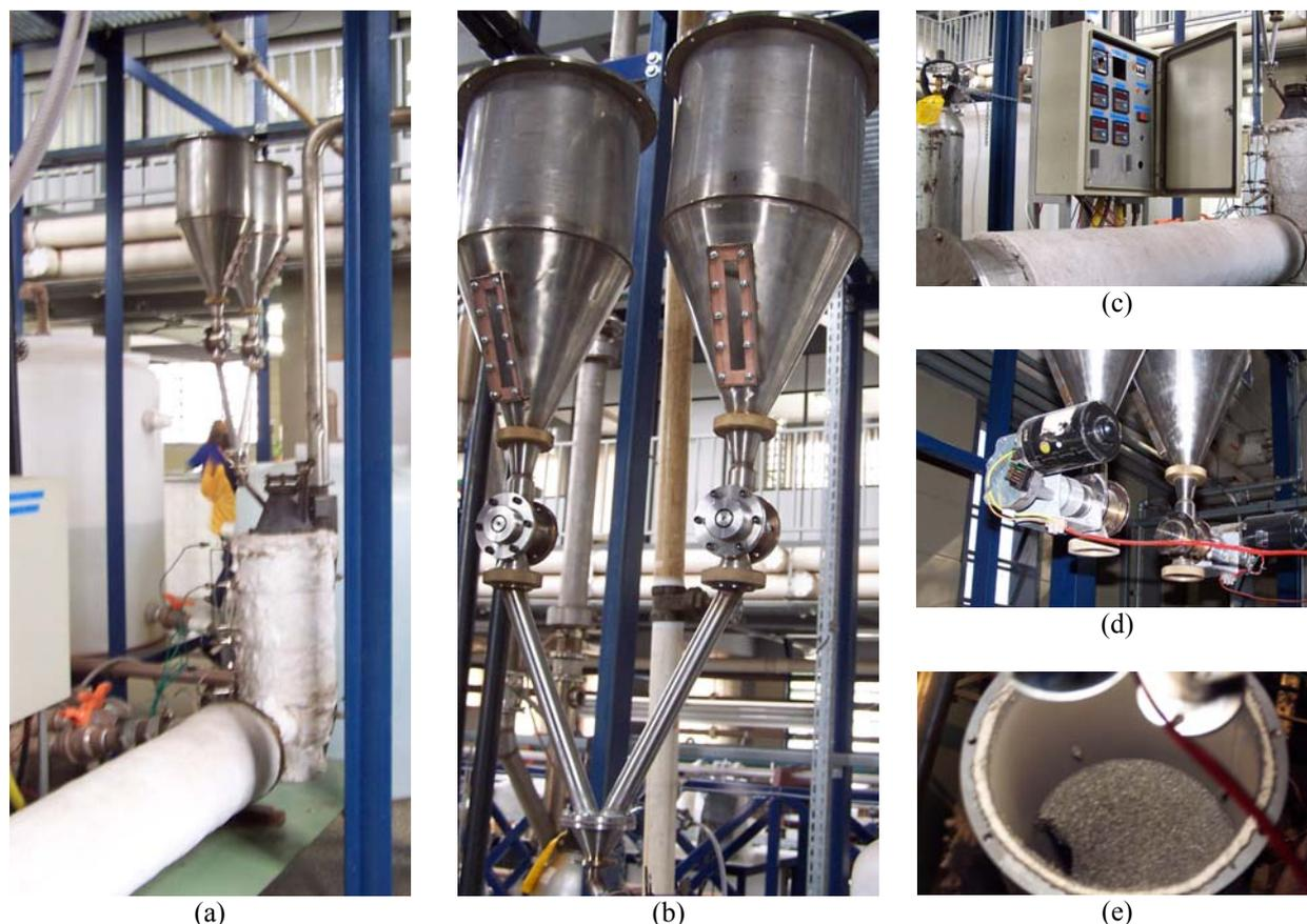
Figura 2. (a) Aquecedor de ar, reator, silos de alimentação de carvão e calcário. (b) Silos de alimentação de carvão e calcário e válvulas de alimentação. (c) Aquecedor de ar, reator, quadro de controle. (d) Válvulas de alimentação de carvão e calcário com motores de acionamento. (e) Reator com material particulado do leito ao fundo.
