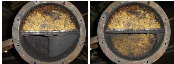
Figura 6. Filtro de casca de arroz após o ensaio.
