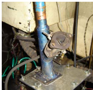
Figura 3. Acoplamento da junta Y no motor.
