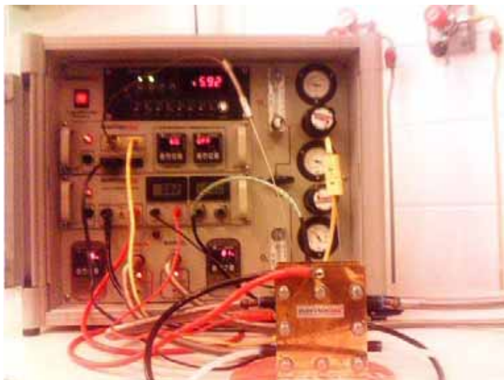
Figura 4: Bancada de testes conectada a célula a combustível de membrana polimérica.
