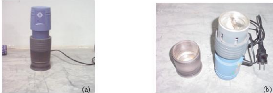
Figura 1 – Triturador de amostras (a) Fechado (b) Detalhe local de colocação da amostra
