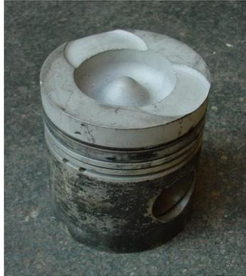
Figura 7 - Pistão original do motor Scania DSI 11.
